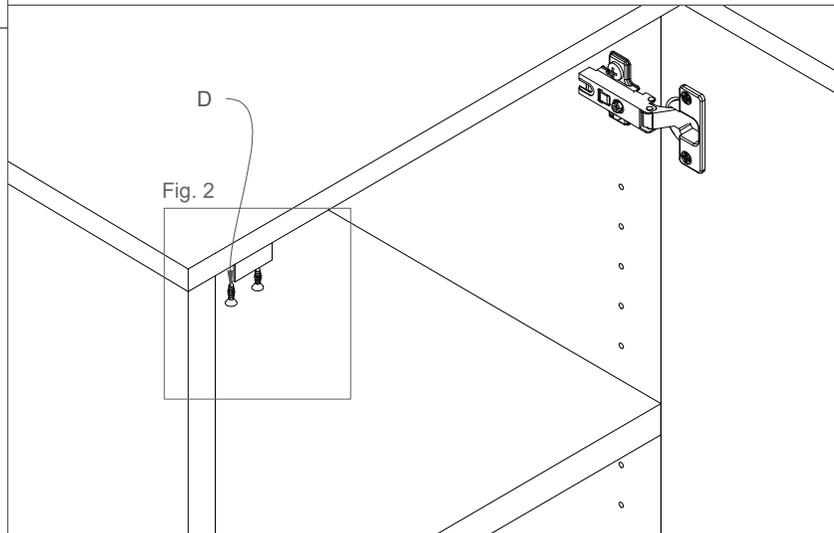
Fig.2 Fissare la linguetta a L (D) nel cappello con 2 viti autofilettanti (B).
