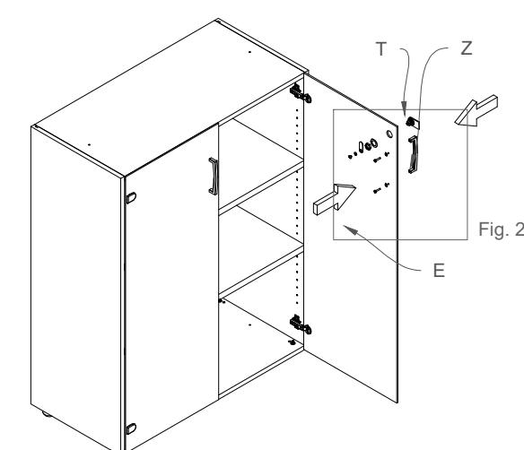
Fig.2 Inserire la maniglia (Z) tramite i bulloni (V) e la serratura (T) tramite le viti.
