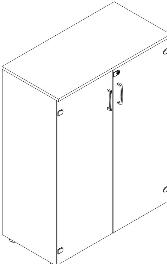
Fig.1 Unire il cappello (C) con il fianco (A) tramite barilotti(O) tiranti (N) e spine (M).
