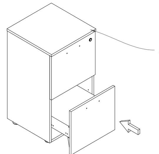
Fig.1 Inserimento delle maniglie (Z) nel classificatore (A) tramite i bulloni (V).
