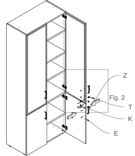
Fig.2 Inserire la maniglia (Z) tramite i bulloni (V) e la serratura (T e K) tramite le viti (R).
