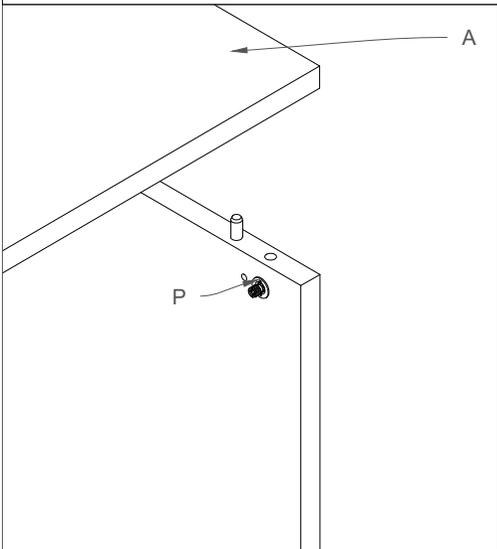
3) Inserire il secondo fianco (A) tramite spine (M) e tiranti (N) e inserire i piedini (U) nella base (B).
