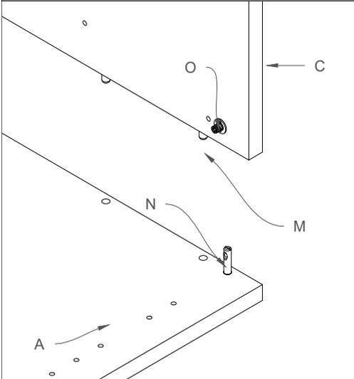
1) Posizionare un fianco (A) sul pavimento, inserendo tramite le spine (M), barilotti (O e X), grani (Y) e i tiranti (N); la base (B), il ripiano strutturale (H) e il cappello (C).
