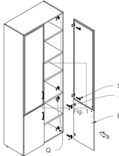
6) Inserire le maniglie (Z) e la serratura (T e K) nell'anta (E).
