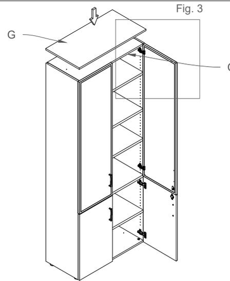
Fig.3 Inserire le viti (I) attraverso le preforature del cappello (C) e forare finché non si aggancia il top (G).
