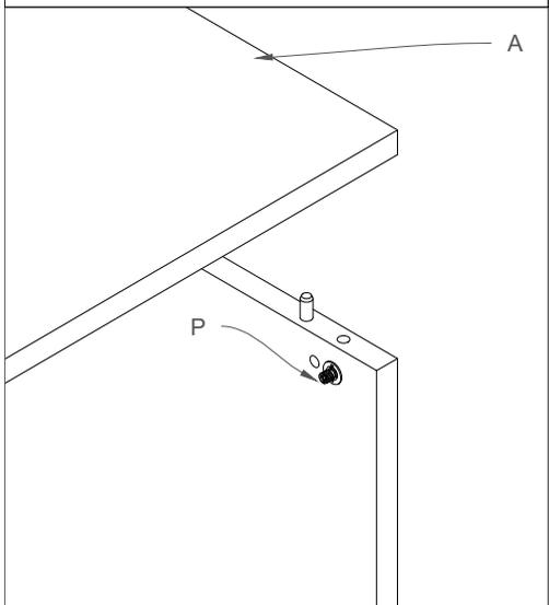
3) Inserire il secondo fianco (A) alla struttura tramite spine (M) e tiranti (N).
