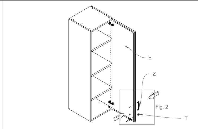
Fig.2 Inserire la maniglia (Z) tramite i bulloni (V) e la serratura (T) tramite le viti.
