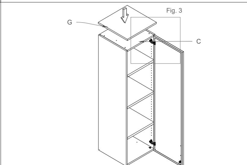
Fig.3 Inserire le viti (R) attraverso le preforature del cappello (C) e forare finché non si aggancia il top (G).
