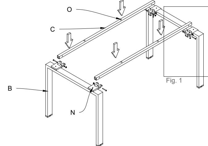
Fig.2 Fissare i bulloni (T e V) nelle travi (C) tramite dado (S) e rondella (Q).
