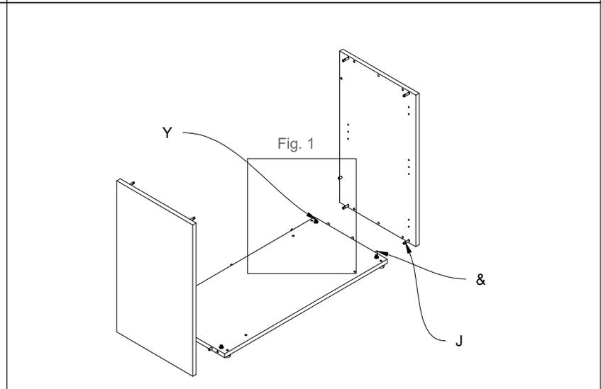
Fig.2 Unire il cappello con i fianchi e il retro tramite le spine (&) e i tiranti (J).
