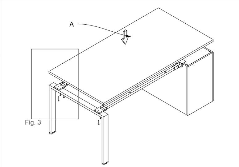
Fig.3 Fissare la struttura al piano (A) tramite i bulloni (U e Z) passando per i distanziali (N).
