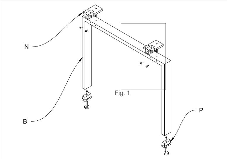
9) Unire le travi (C) con il mobile (E) la gamba (B) tramite i distanziali (N) e l'elemento di giunzione (D) e inserire i paracolpi (O).
