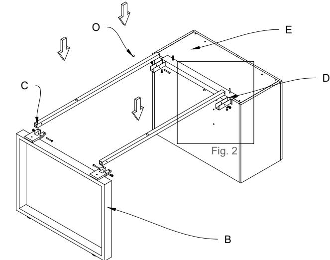
Fig.2 Fissare i bulloni (U e V) nell'elemento di giunzione (D) tramite dado (S) e rondella (Q).
