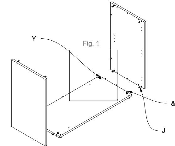
Fig.2 Unire il cappello con i fianchi e il retro tramite le spine (&) e i tiranti (J).
